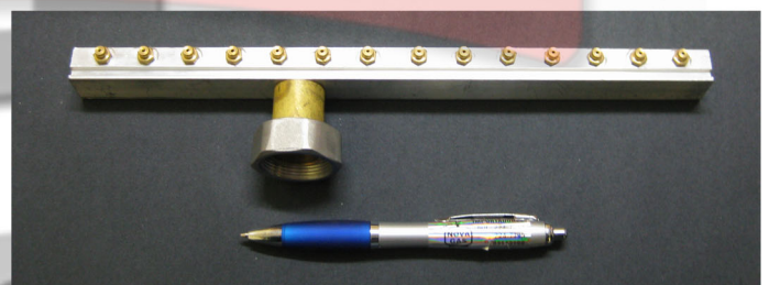
TUBO DISTRIBUIDOR DE GAS NATURAL
